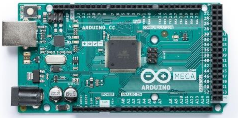
Obr. 4-1: Vývojová deska Arduino MEGA 2560 [6]
