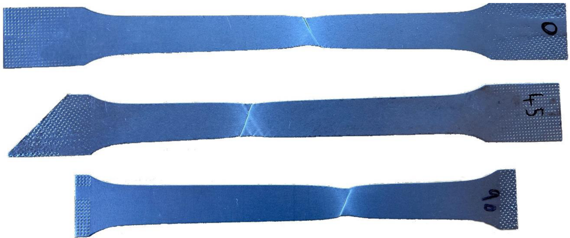
Obr. 3.3 Ukázka jednoho porušeného zkušební vzorku z každé sady
