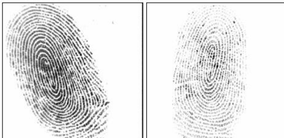
Obrázek 15: identické otisky, různý tlak prstu na senzor [7]
