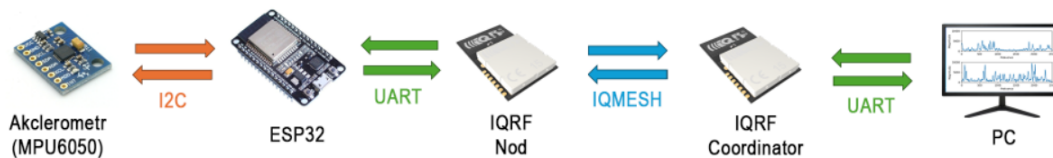
Obrázek 4.10: Struktura měřicí sítě využívající IQMESH
