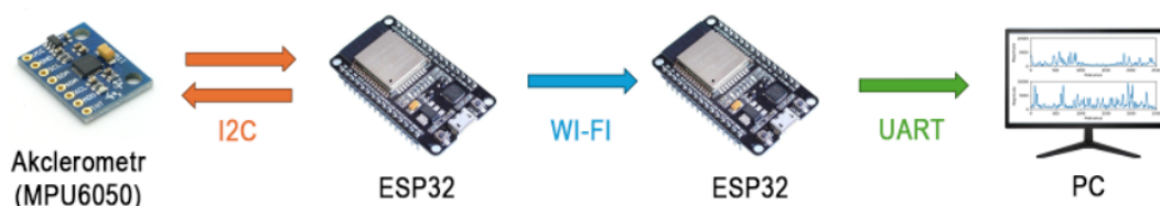
Obrázek 4.1: Struktura měřicí sítě využívající Wi-Fi mesh
