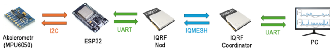
Obrázek 4.10: Struktura měřicí sítě využívající IQMESH
