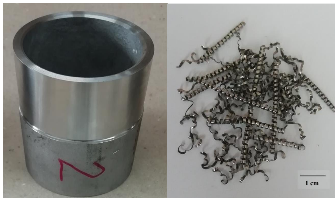
Obr. 27 Vľavo vzorka číslo 2, vpravo trieska.
