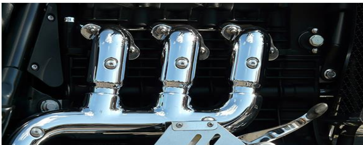
Obr. 3 Potrubie z austenitickej ocele [7].
