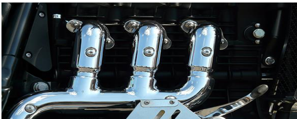
Obr. 3 Potrubie z austenitickej ocele [7].
