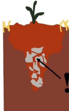
Obrázek 7 Zpracování za nevhodných podmínek, tvorba vzduchových kapes (Brant, a další, 2016)
