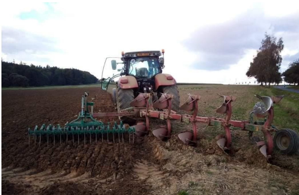
Obrázek 1. Orba neseným oboustranným šestiradličným pluhem Kverneland se spojením operace drcení hrud. (foto autor)
