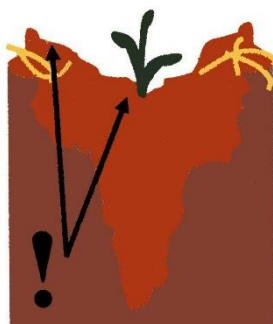
Obrázek 5 Vyhozená půda mimo řádek vlivem špatného seřízení stroje (Brant, a další, 2016)
