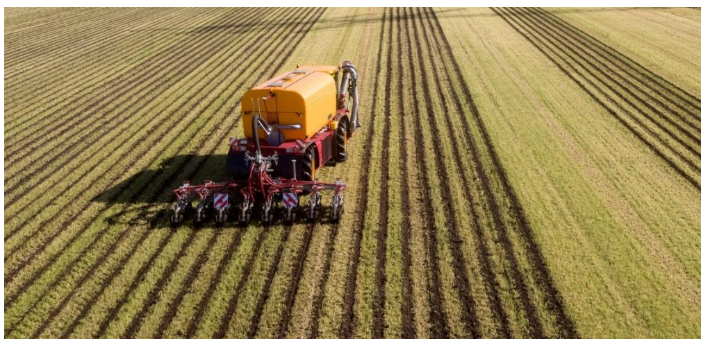
Obrázek 12 Aplikátor tekutých hnojiv vogelsang (Vogelsang GmbH & Co.KG)
