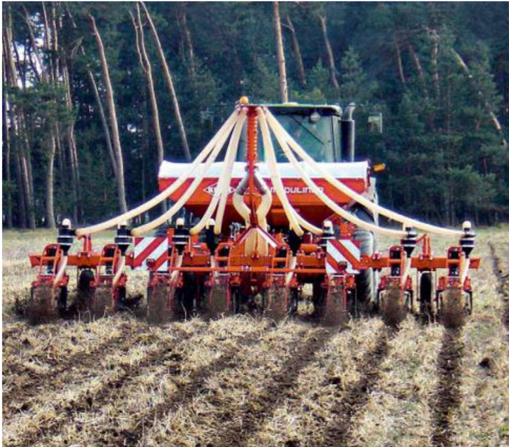
Obrázek 16 Kuhn striger se zásobníkem hnojiva vzadu (Kuhn center CZ a.s.)
