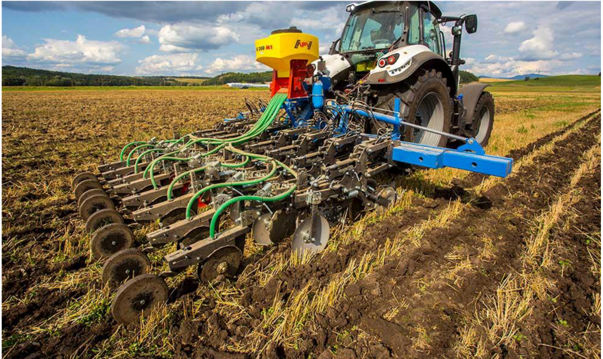
Obrázek 17 P&L Seed tiller stroj pro pásové zpracování půdy s výsevním zařízením (P&L, spol s.r.o.)
