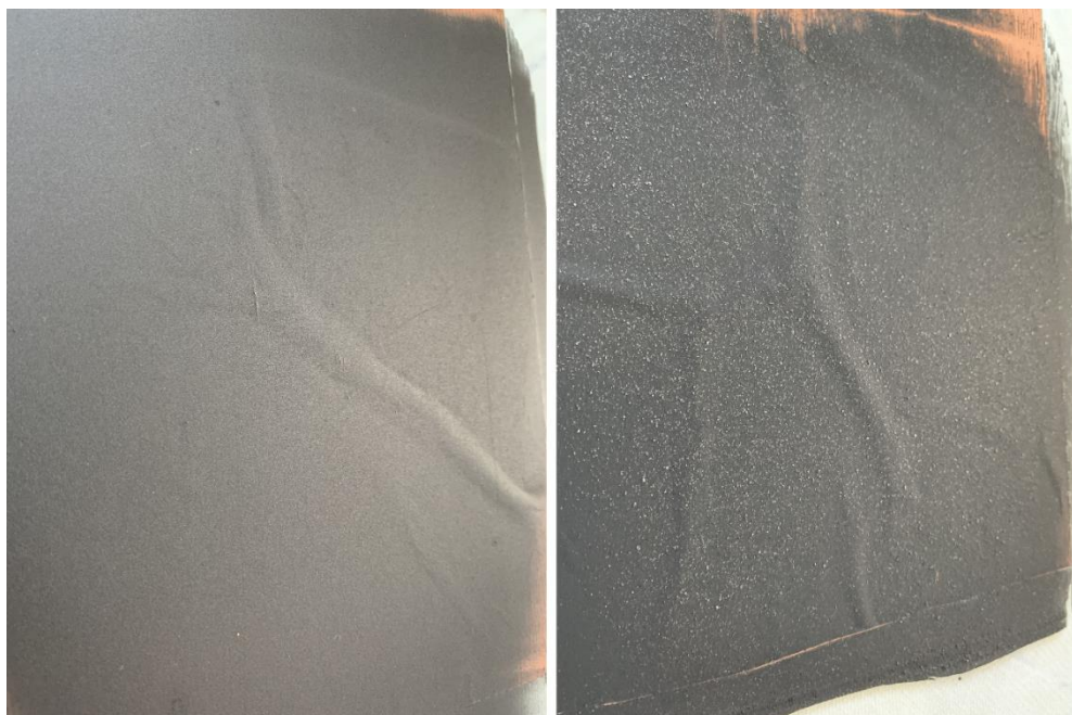
Obr. 7.2: Detailní záběr na rozdílnou strukturu vysušených elektrodových hmot. Vlevo grafit vločkový, vpravo grafit expandovaný s označením 3626
