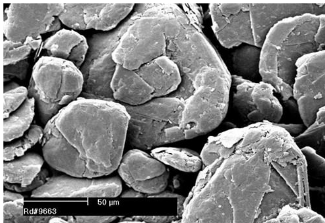
Obr. 4.3: Vločkový grafit o průměru vloček 50 \mu\text{m} , pořízeno pomocí SEM - Rastrovací elektronový mikroskop [31]
