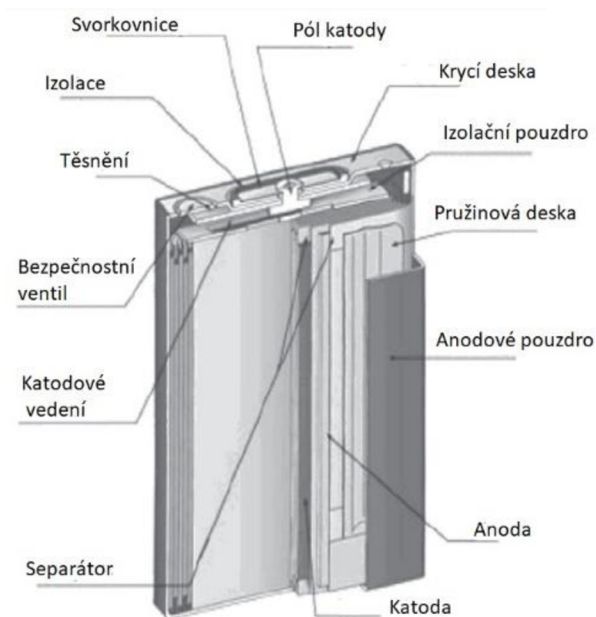
Obr. 3.1: Prismatic (hranolový) článek je prostorově úsporný, využití nachází jako externí baterie [18]
