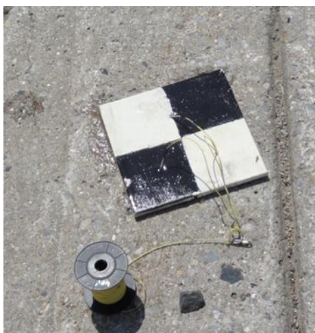
Obrázek č. 7: Vyrobená Secchiho deska (vlastní fotografie)
