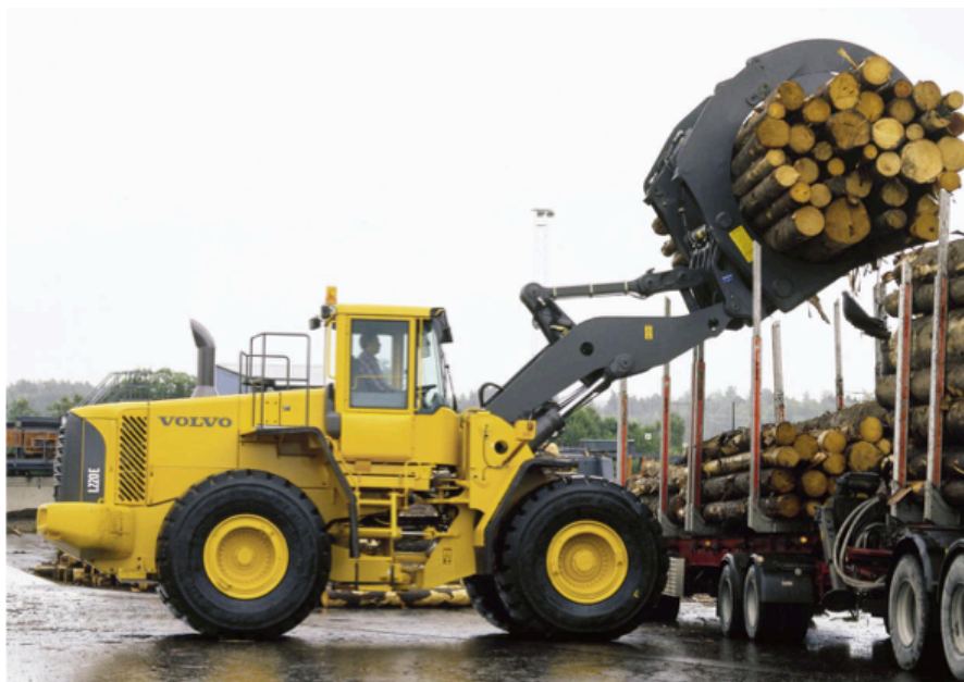
Obr. 7: Schéma čelního nakladače s drapákem (VOLVOCE.COM 9. 3. 2022)
