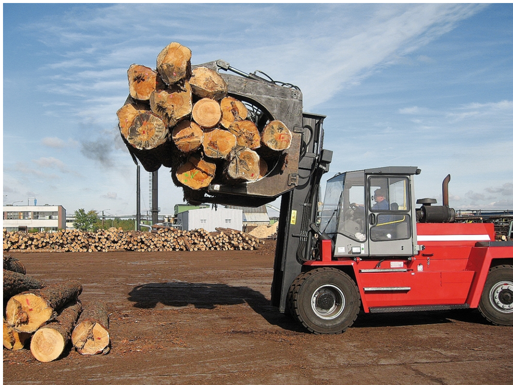
Obr. 8: Čelním nakladač s drapákem, pojízdným na svislém vedení ( https://www.stabau.com/en/products/specialsolutions/commercial-vehicles/9 . 3. 2022)
