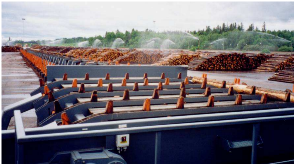
Obr. 6: Postřik suroviny stabilními postřikovači (Janák, 2008)
