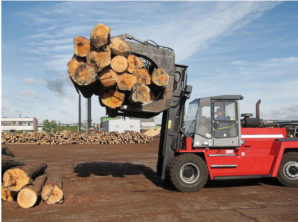
Obr. 8: Čelním nakladač s drapákem, pojížděným na svislém vedení ( https://www.stabau.com/en/products/specialsolutions/commercial-vehicles/9 . 3. 2022)
