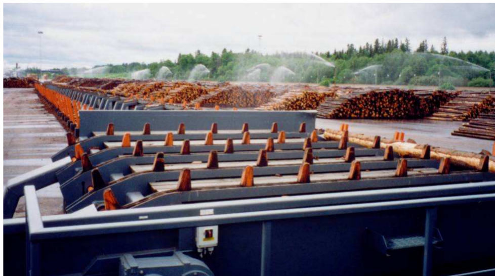
Obr. 6: Postřik suroviny stabilními postřikovači (Janák, 2008)
