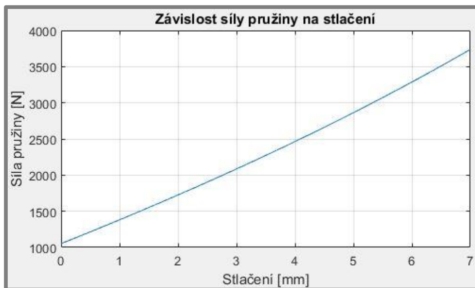
Obr. 22 Závislost síly pružiny na stlačení 7 mm
