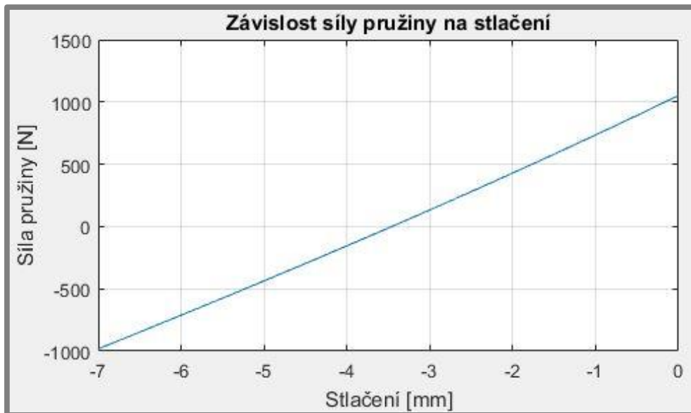
Obr. 23 Závislost síly pružiny na stlačení - 7 mm
