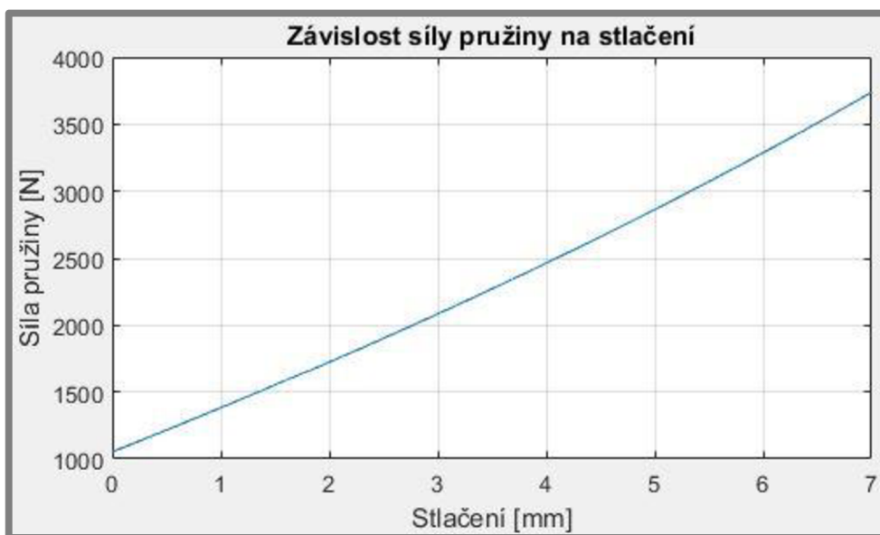
Obr. 22 Závislost síly pružiny na stlačení 7 mm
