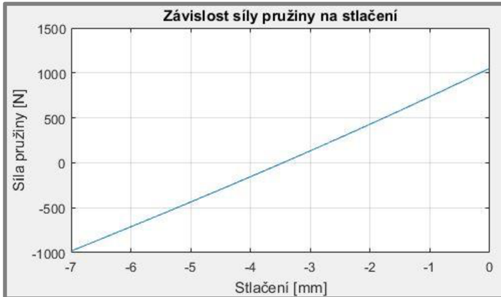
Obr. 23 Závislost síly pružiny na stlačení - 7 mm
