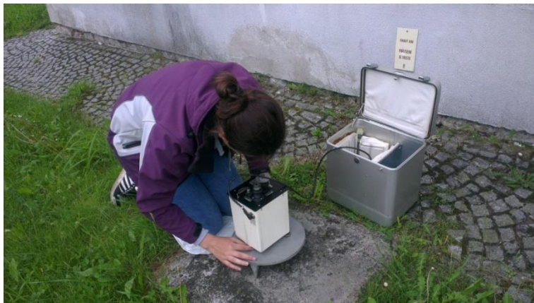
Obr. 18. Meranie prístrojom La Coste & Romberg G-176
