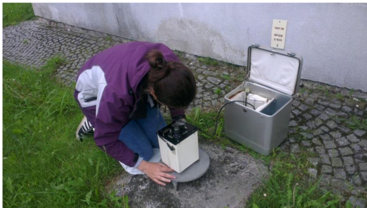
Obr. 18. Meranie prístrojom La Coste & Romberg G-176
