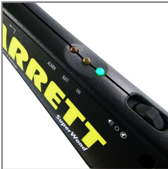
Obr. 2-5 Detail ovládacích prvků Super Wand (Garrett) [11]
