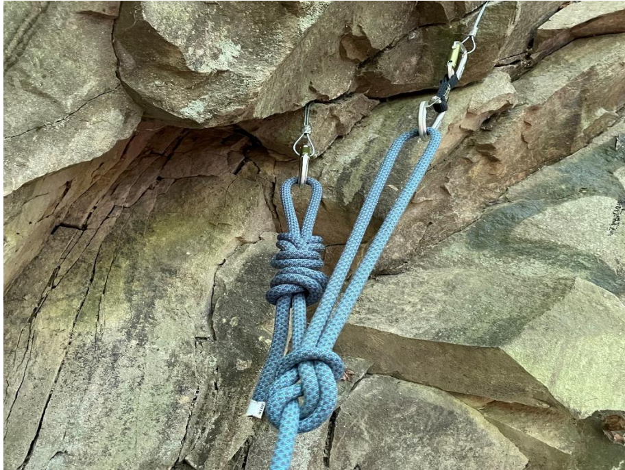
Obrázek 9. Vytvoření jistícího stanoviště z jednoho pramene dynamického lana ke dvěma kotevním bodům (2x vklíněnce). Využití dvojité osmičky zajištěné pojistným uzlem a druhé částečné dvojité osmičky. Zúžitkování lana do tvaru Y k rozložení působících sil, 2021
