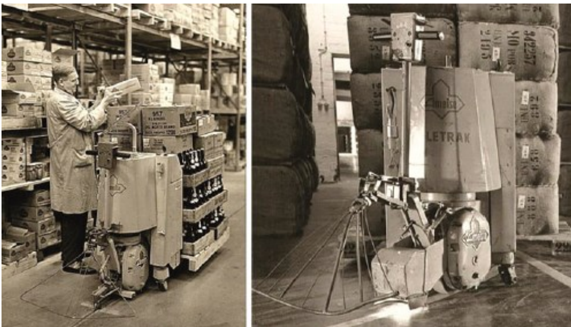
Obr. 1.2 Ameise/Teletrak – prvé opticky navádzané AGV
