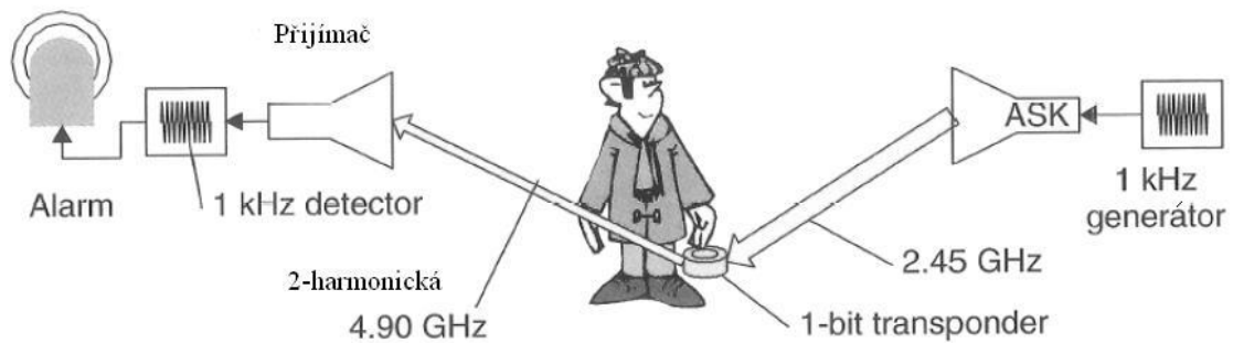
Obr. 1.8 – Princip mikrovlnného RFID tagu [6]
