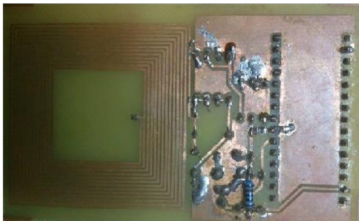
Obr. 3.14 - Vyrobený a osazený emulátor HF RFID tagu – zadní strana
