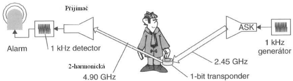
Obr. 1.8 – Princip mikrovlnného RFID tagu [6]
