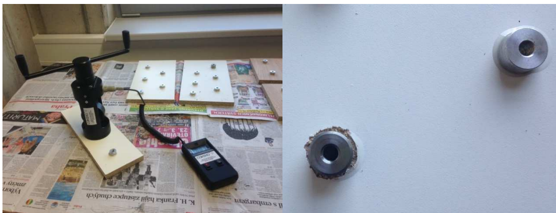
Obr. 19 vlevo - Přístroj na měření odtrhové pevnosti COMTEST OP 1 P 20
