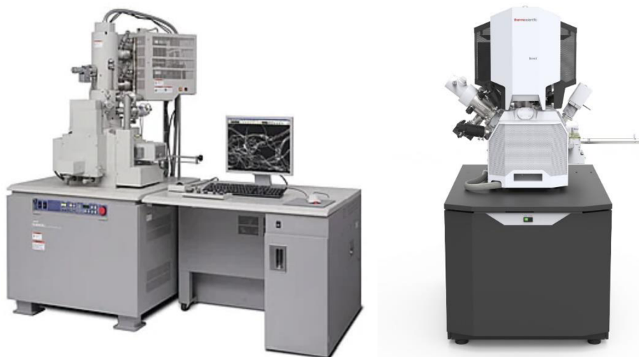
Obrázok 6.7: SEM snímky vzoriek tenkých filmov \text{Fe}_2\text{TiO}_5 boli vyhotovené na mikroskopoch SU6600 (Hitachi) citácia a Scios2 DualBeam (ThermoFisher SCIENTIFIC) citácia. Mikroskop SU6600 bol použitý aj na získanie EDS spektier pripravených vzoriek [90, 91].
