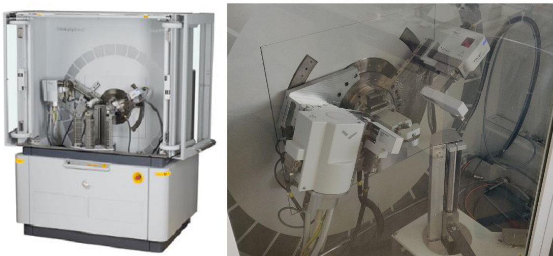
Obrázok 6.8: RTG difraktogramy pripravených vzoriek tenkých filmov boli zaznamenané pomocou RTG difraktometra Empyrean (PANalytical) v geometrii grazing incidence XRD (GIXRD) [92].
