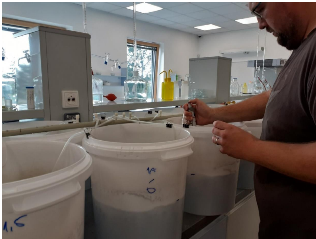
Obr. č. 7 Dávkování amoniaku do systému (foto autor).
