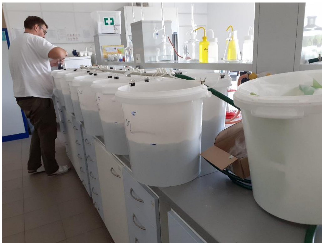
Obr. č. 6 Fotka znázorňuje experimentální jednotku simulující biofiltr akvaponického systému (foto autor).
