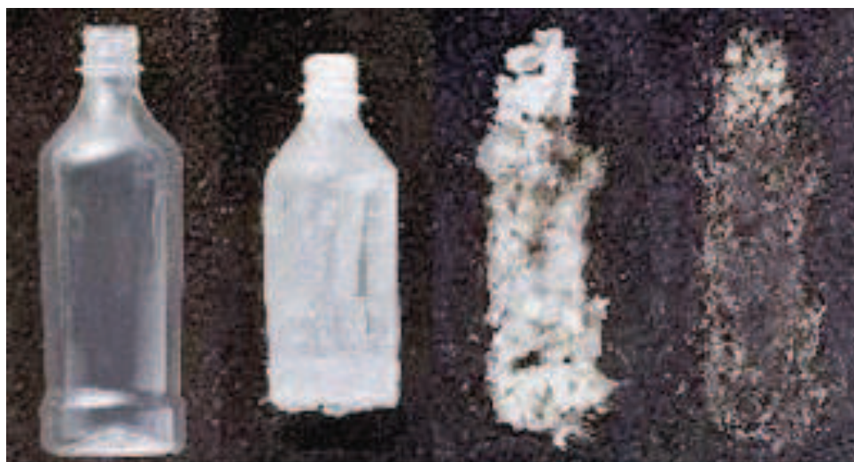
Obr. 7: Biodegradace PHA lahví v půdě, dvouměsíční expozice [18]
