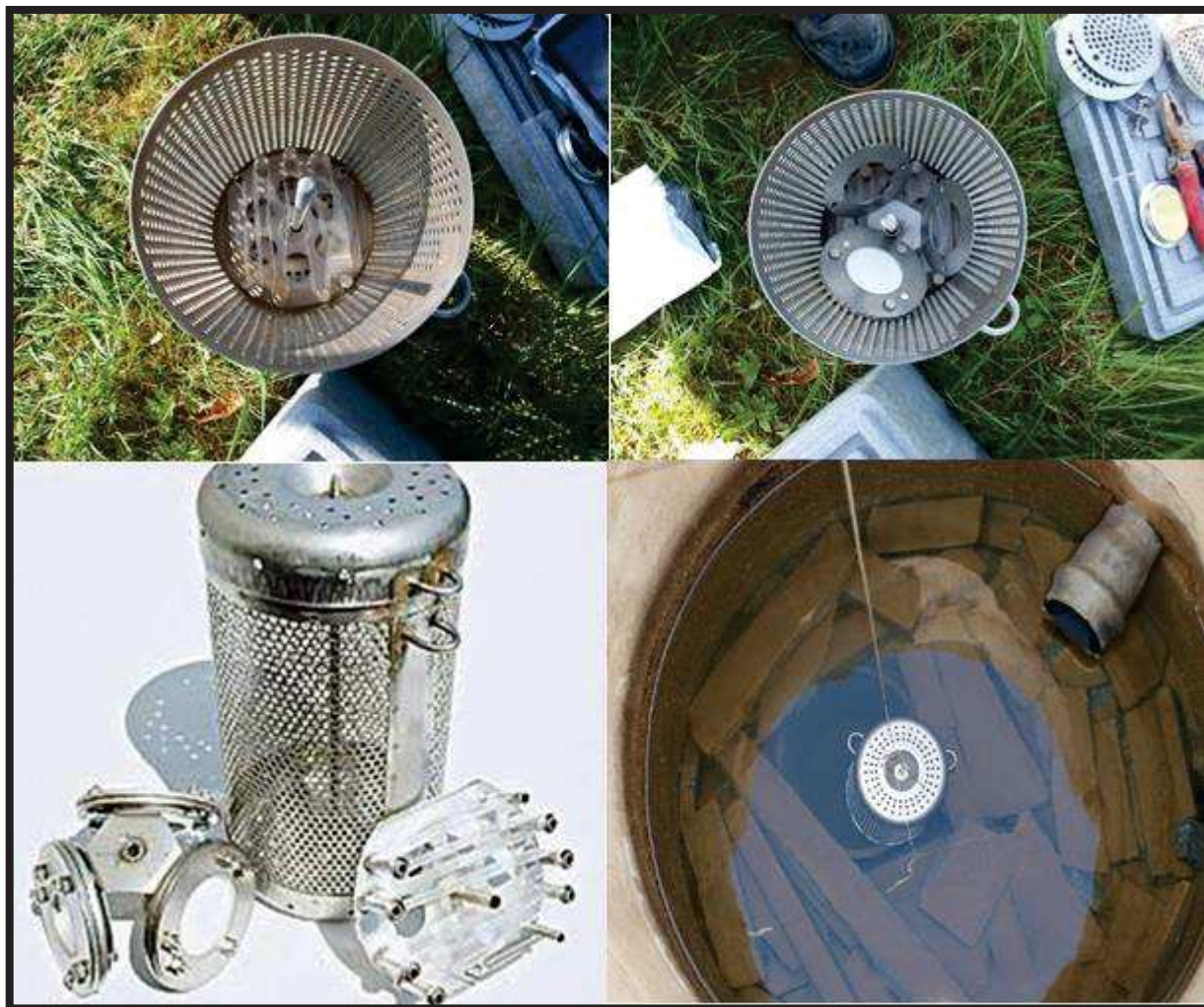
Obr. 4: Pasivní vzorkovač POCIS a jeho umístění ve vrtu P10 (Onšovice)
