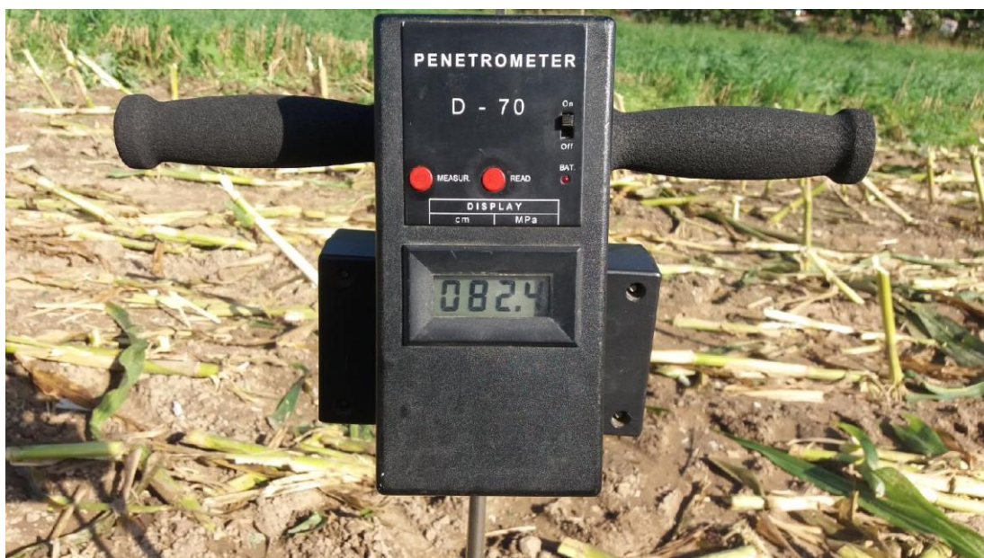
Obrázek 4 - Měřicí přístroj Penetrometer D-70 při měření (foto R. Šimek)
