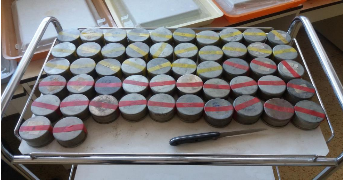
Obrázek 19 - Válečky připravené v laboratoři na vážení a vysoušení. Červené označení stanoviště ORBA a žluté, stanoviště MINIMALIZACE (foto. R Šimek)
