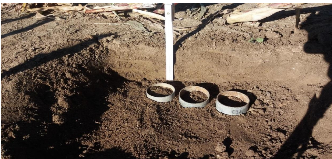
Obrázek 18 - Odebírání půdních vzorků pomocí Kopeckého válečku (foto. R. Šimek)
