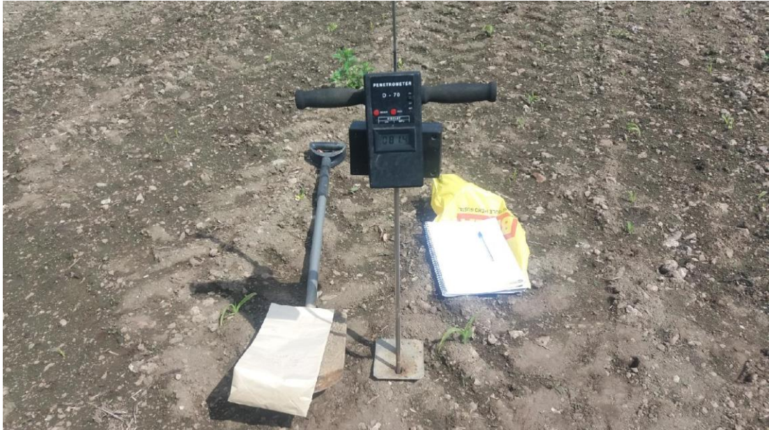
Obrázek 16 - Odebírání vzorků půdy a penetrometrické měření odporu na stanovišti CHI - kolejový řádek (foto. R. Šimek)
