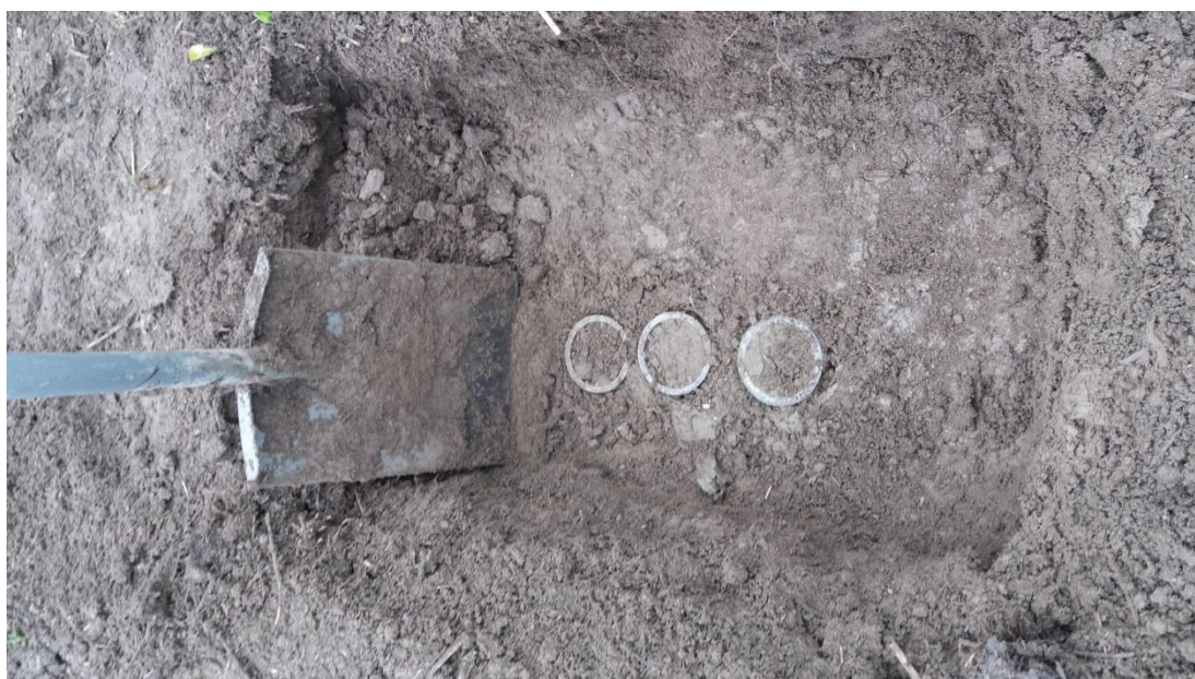
Obrázek 5 - Odběr půdních vzorků, konkrétně z hloubky 25 cm (foto R. Šimek)
