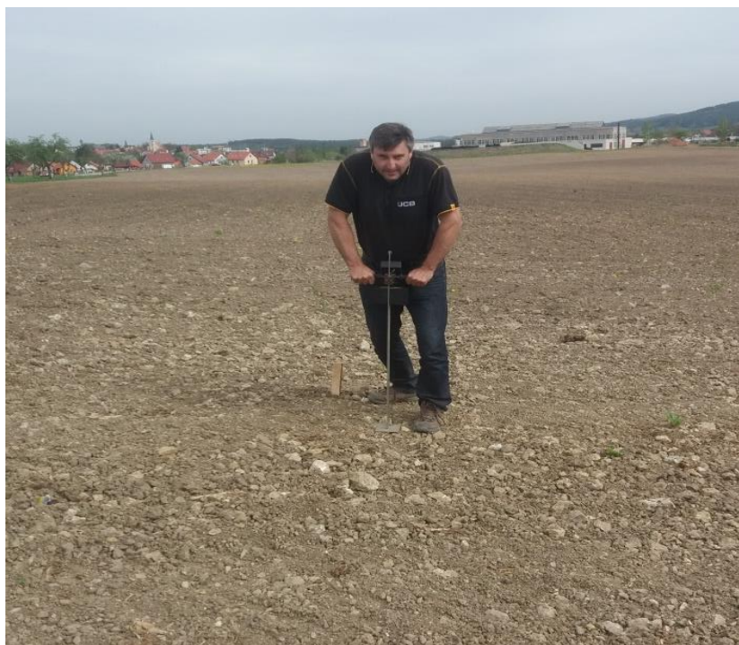
Obrázek 15 - Měření penetrometrického odporu na stanovišti CH2 – pole (foto. R. Šimek)
