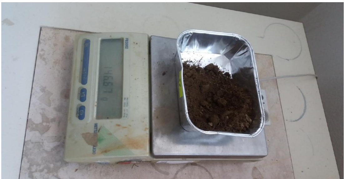
Obrázek 17 - Vážení půdních vzorků v laboratoři (foto. R. Šimek)
