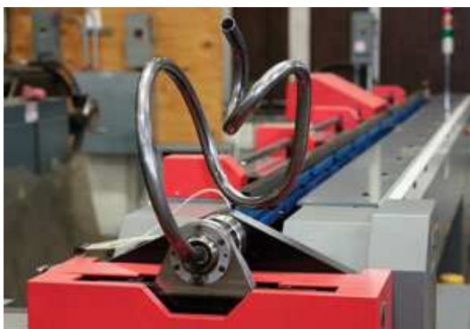
Obr. č. 21: proces flexibilního ohybu [9]
