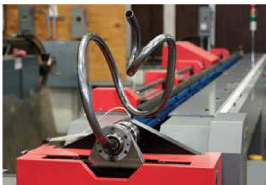
Obr. č. 21: proces flexibilního ohybu [9]
