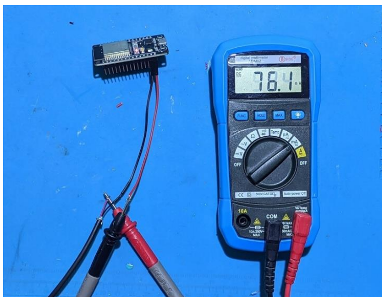
Obrázek 6: Měření proudu v klidovém stavu (45)
