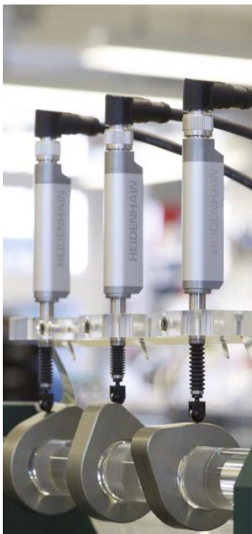
Obr. 4) Výstupní kontrola vačkové hřídele [10]
