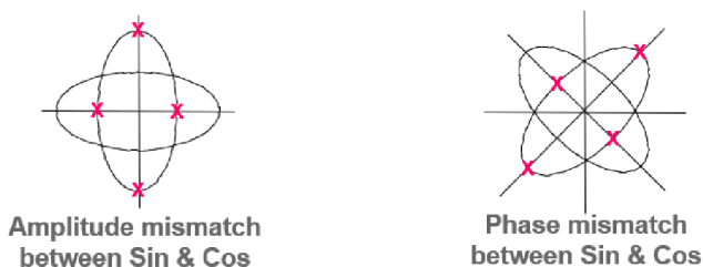
Obr. 30) Vliv chyby analogového signálu na tvorbu Lissajousovy kružnice [24]
