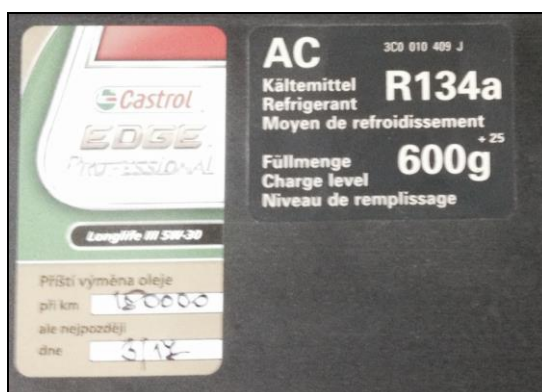
Obr. 18: Informace o chladicím médiu k diagnostikovanému vozidlu č. 1
