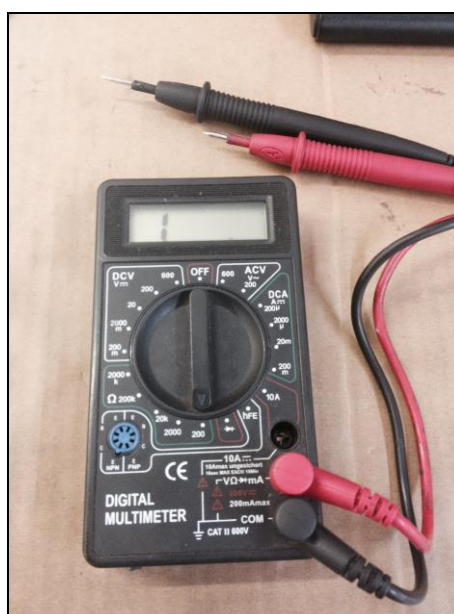
Obr. 19: Multimetr využívaný při měření elektroinstalace
