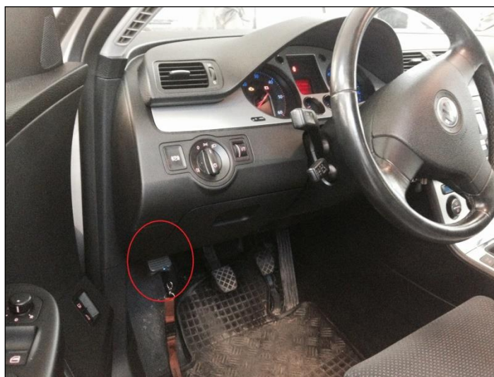
Obr. 15: Zapojení konektoru OBD-II přes bluetooth
