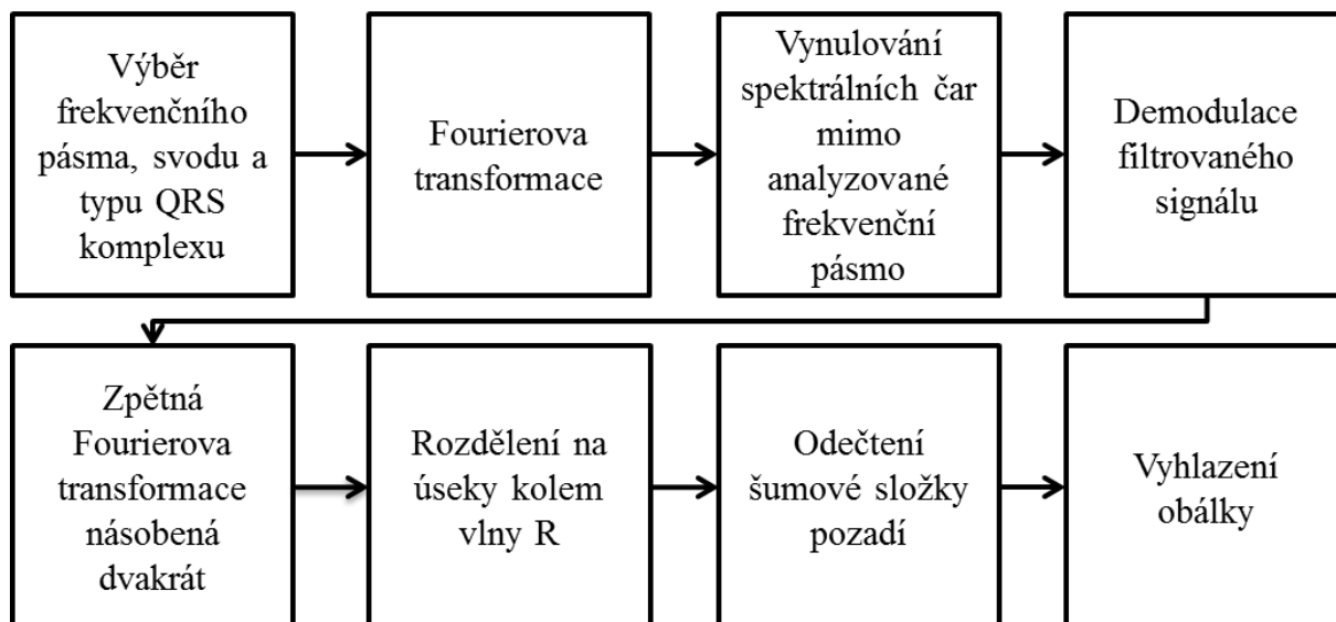
Obr. 63 Blokové schéma algoritmu pro tvorbu nízkofrekvenční obálky vysokofrekvenčního signálu
