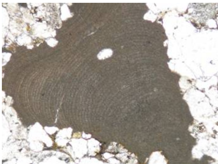
Obr. 14 Lokalita Šraňky – alochem pravděpodobně červené řasy. PPL. Šířka snímku 2 mm.
