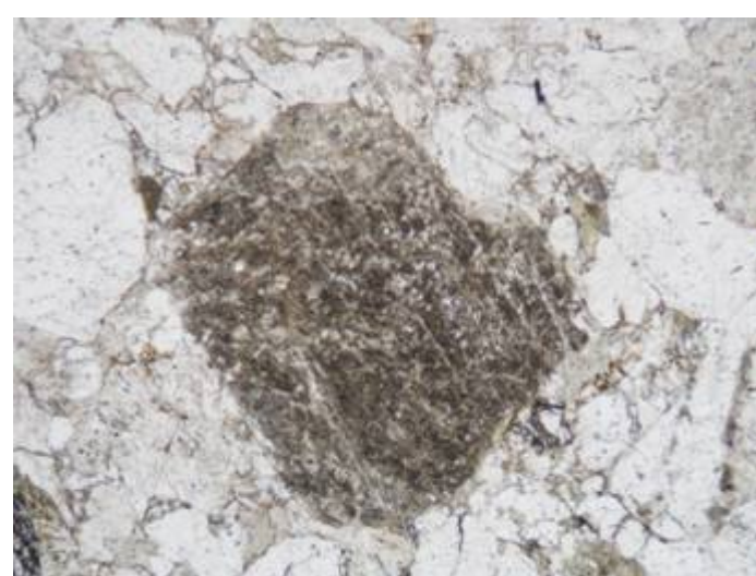
Obr. 15 Lokalita Šraňky – alterace K - živce. PPL. Šířka snímku 2 mm.
