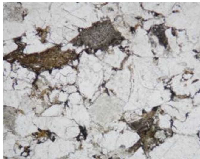
Obr. 17 Lokalita Německý lom – úlomky jílovitých břidlic v pískovci. PPL. Šířka snímku 2 mm.
