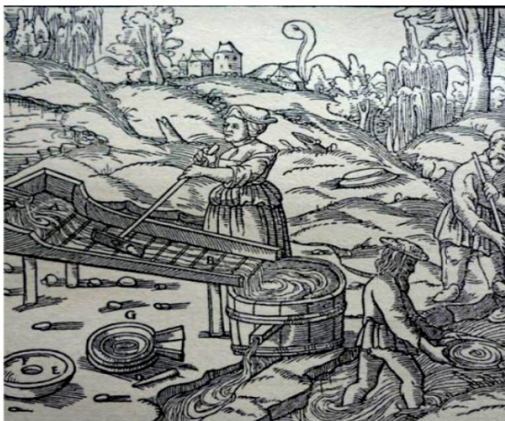
Obr.24.: Rýžovnický splav na separaci zlatinek. Upraveno podle Agricola (1556).
