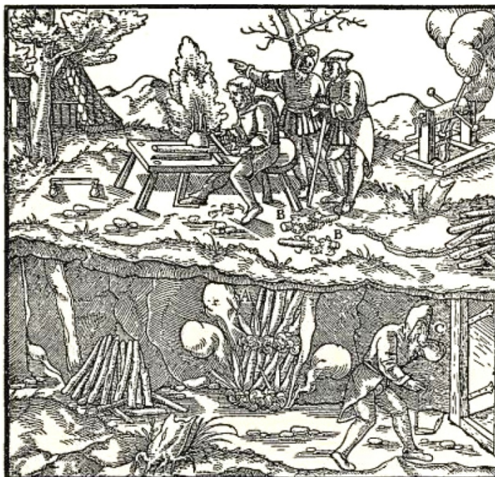
Obr.21.: Proces sázení ohněm ve štole. Upraveno podle Agricola (1556).
