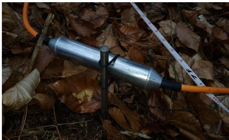
Obr.38a.: Kovové elektrody. Použito z internetového zdroje: ( http://www.gfinstruments.cz ).
