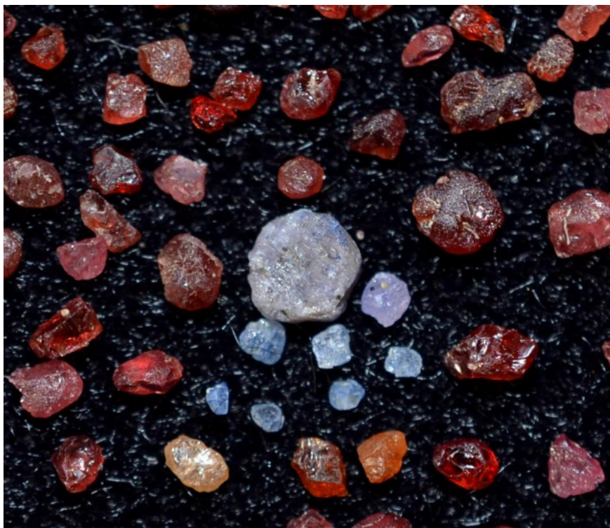
Obr.76.: Těžký podíl sedimentů z řeky Otavy. Červené minerály jsou české granáty, zirkony a spessartiny. Modré valounky uprostřed reprezentují korundy (safíry). Šířka záběru 1,5 cm.
