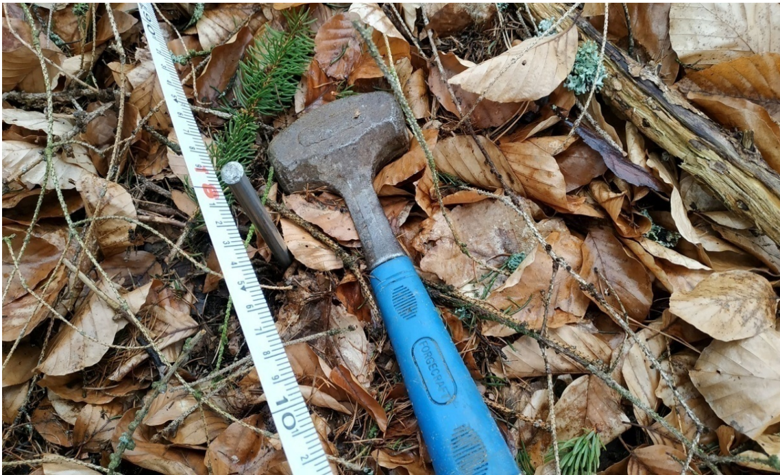
Obr.60.: Geologické kladívko na zatlókání elektrod. Foto: D. Šefčík, 2020.
