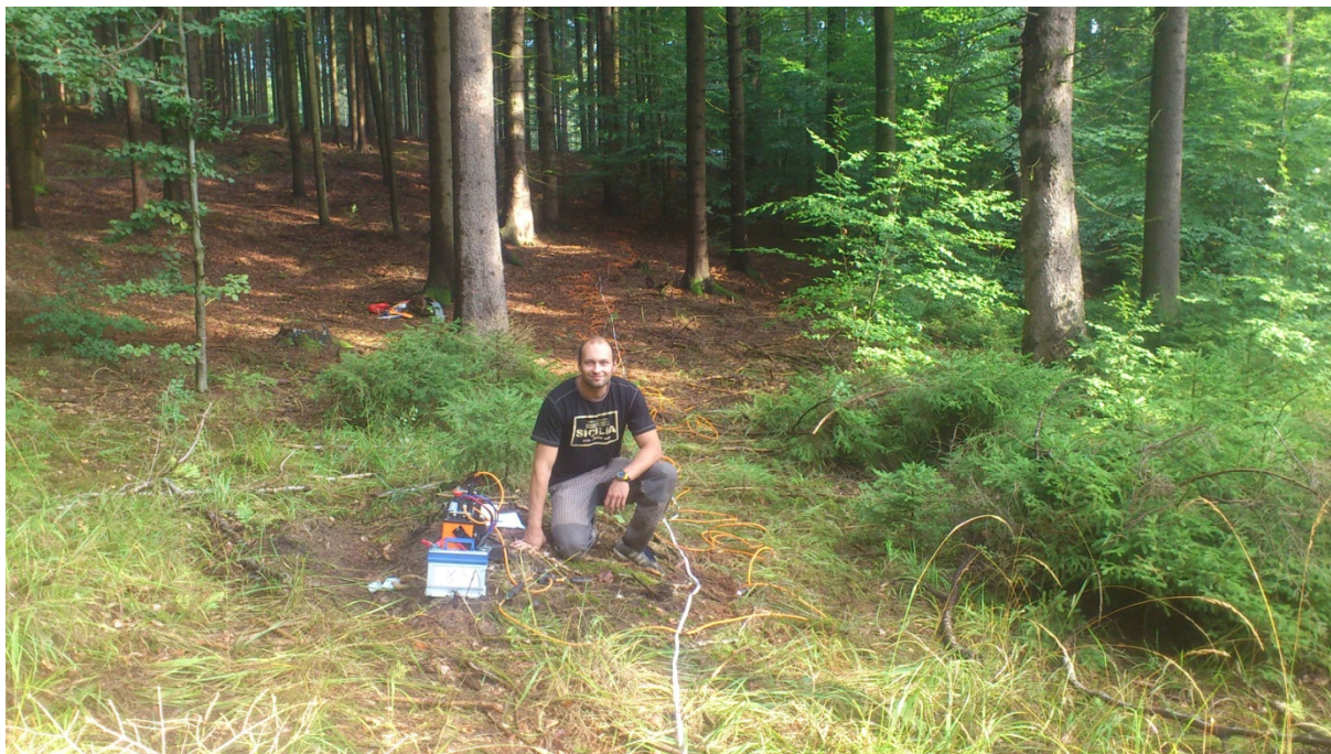
Obr.62.: Vytyčení profilu pomocí pásma a propojení multielektrodového kabelu s měřicí aparaturou ARES na lokalitě "Na Kometě". Foto: S. Dvořáčková, 2019.
