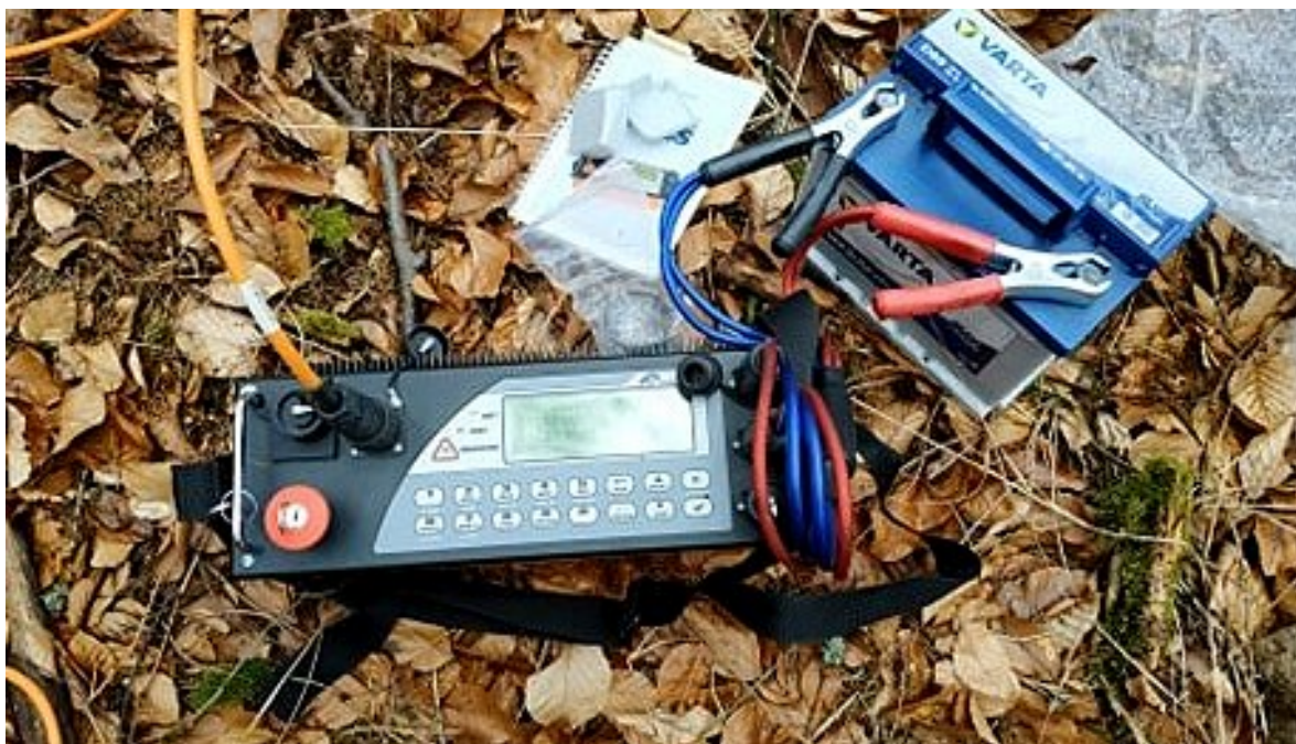
Obr.64.: Zapojená aparatura ARES 200E ke zdroji napětí a k multielektrodovému systému. Foto: D. Šefčík, 2020.
