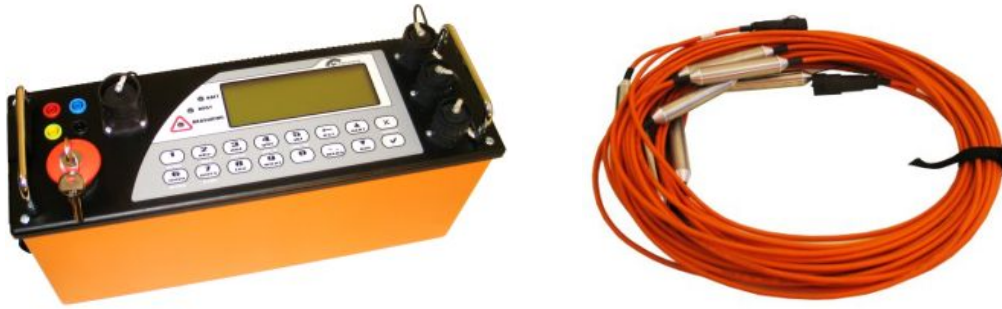
Obr.37: Vlastní aparatura ARES-200E s multielektrodovým kabelem.
