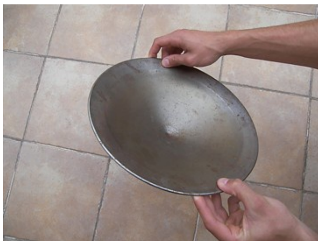
Obr.23.: Rýžovnická kovová pánev k separaci zlata. Foto: D. Šefčík.
