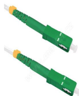
Obrázek 14: Patch cord, flexibilní vlákno G.657.B3. 9/125, SC/APC-SC/APC, simplex, 1 m, bílý (Zdroj: [13])
