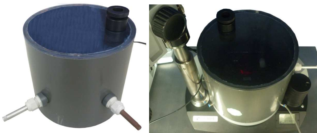
Obr. 1.8: Komora na regulaci vlhkosti samostatně a umístěna na AFM mikroskopu.
