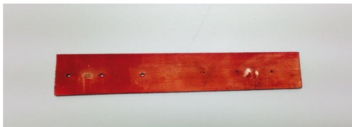
Obr.25. Výsledné pokovenie vzorku
