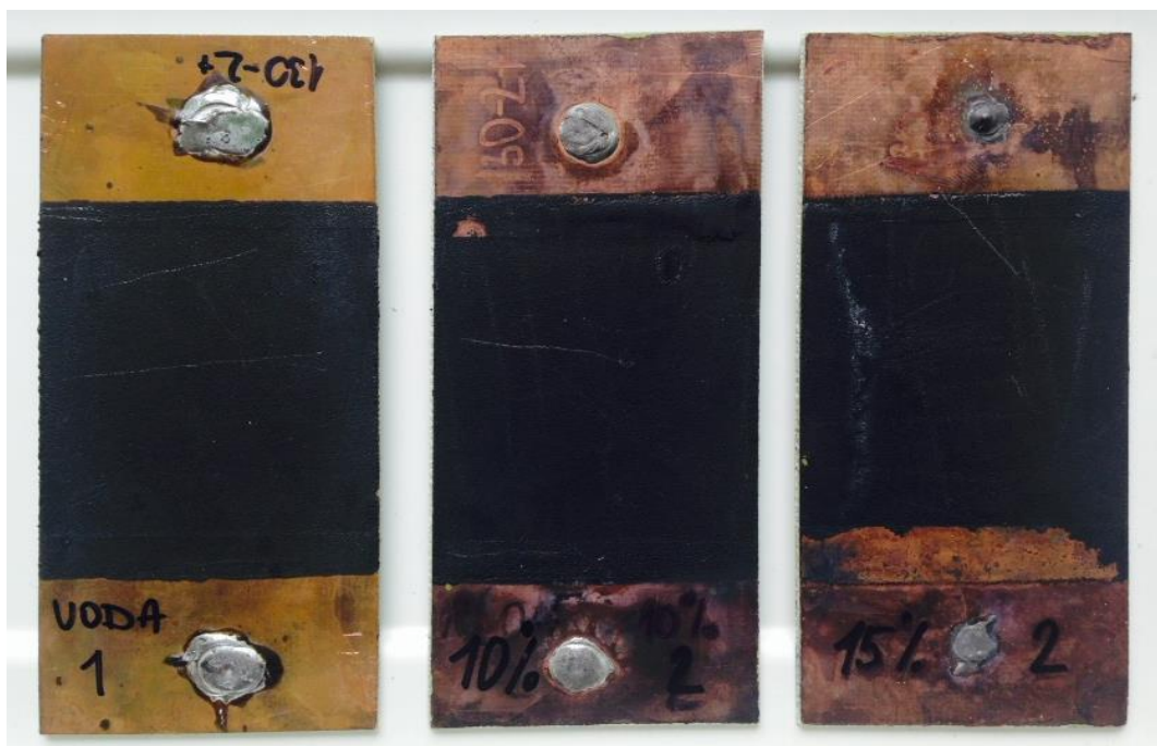
Obr.28. Vzorky vytiahnuté z kvapalín po 24 hodinách, z ľavej strany: voda, 10 % NaOH, 15 % NaOH
