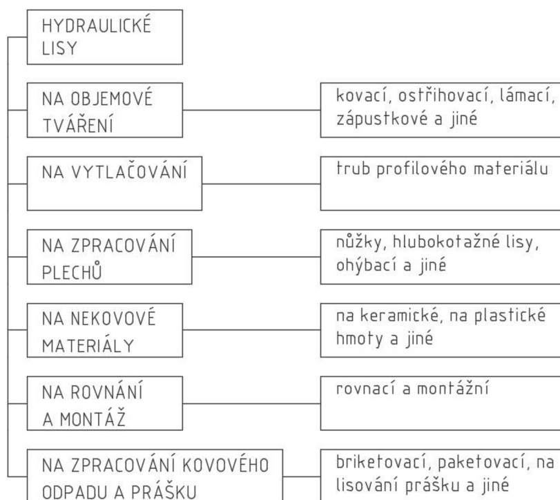
Tab 2) Rozdělení hydraulických lisů podle způsobu použití. [1]
