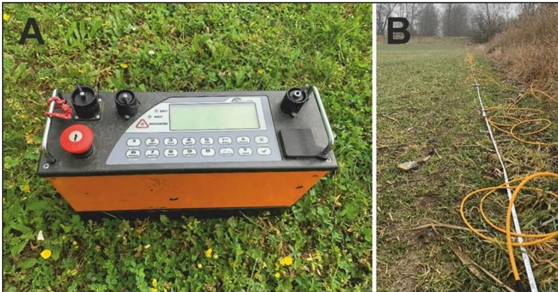
Obr. 17: Měření elektrické odporové tomografie v bývalém Závořickém rybníku. A – řídicí jednotka; B – propojení hrotů s multielektrodovými kabely (foto: Lukáš Maloušek).
