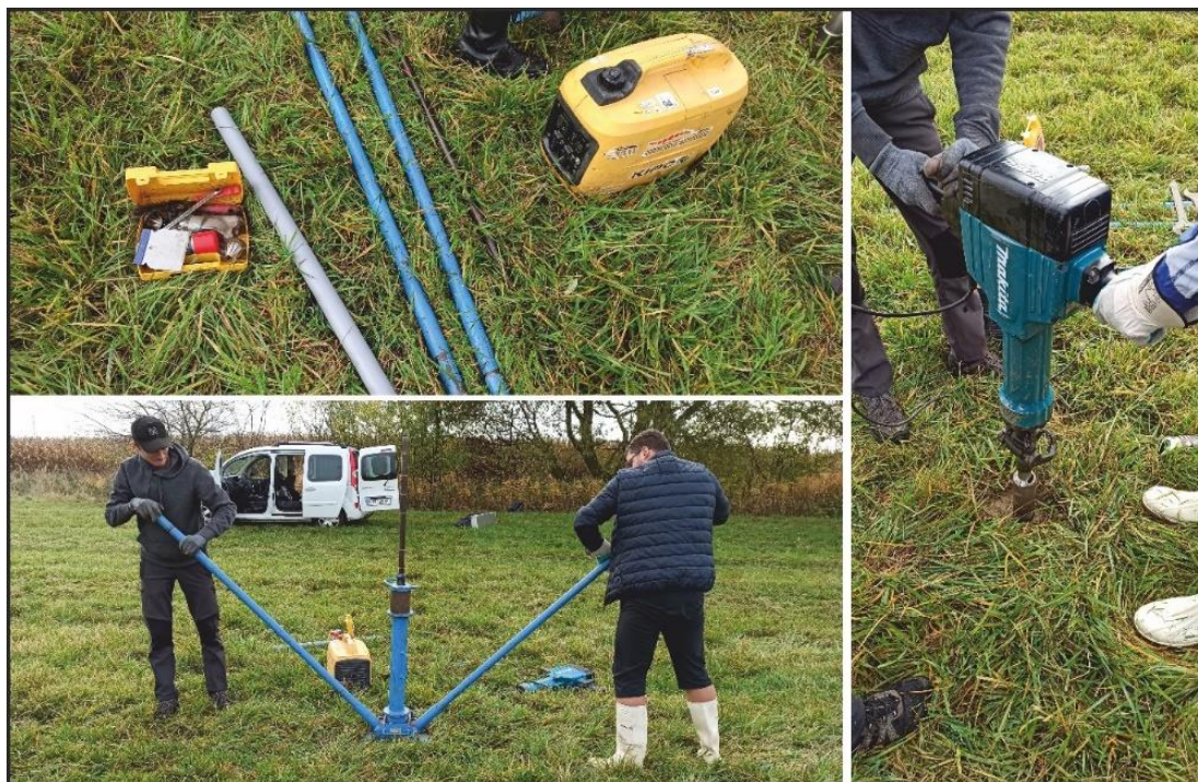
Obr. 18: Odebírání vzorků pomocí pneumatické vrtné soupravy (foto: Michal Plánka).
