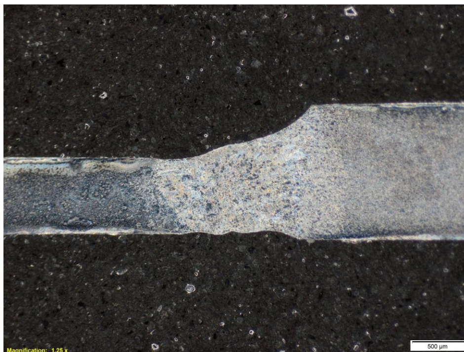
Obr. 57 Makrostruktura svařence A0,7B1,25 / 0 A.
