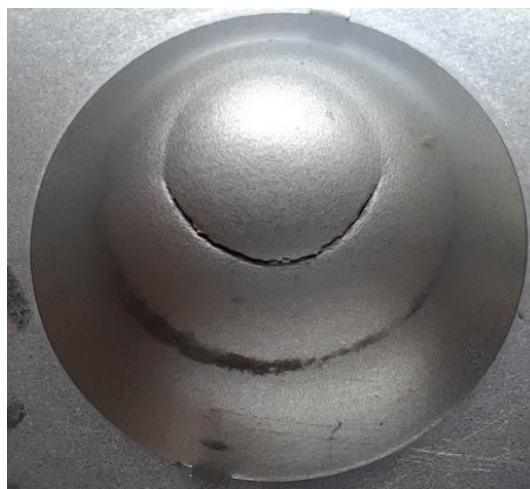
Obr. 53 Typická trhlina v ZM.
