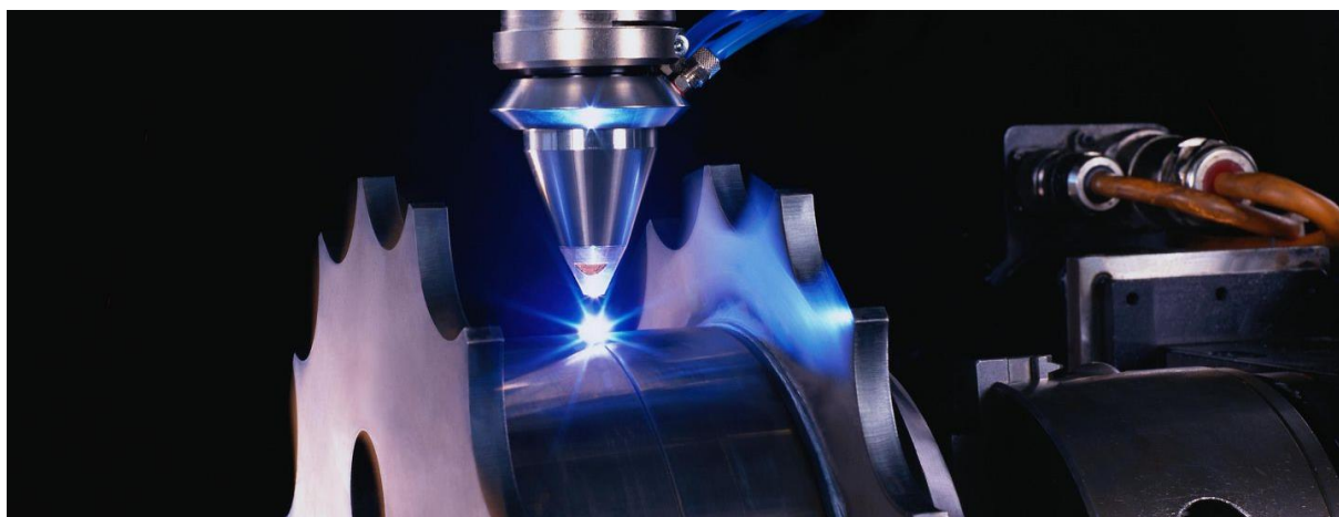
Obr. 1 Technologie svařování laserovým paprskem [5].
