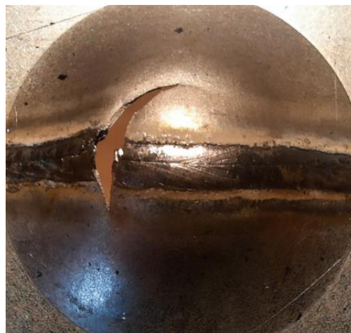
Obr. 56 Trhlina přes ZM i svar.
