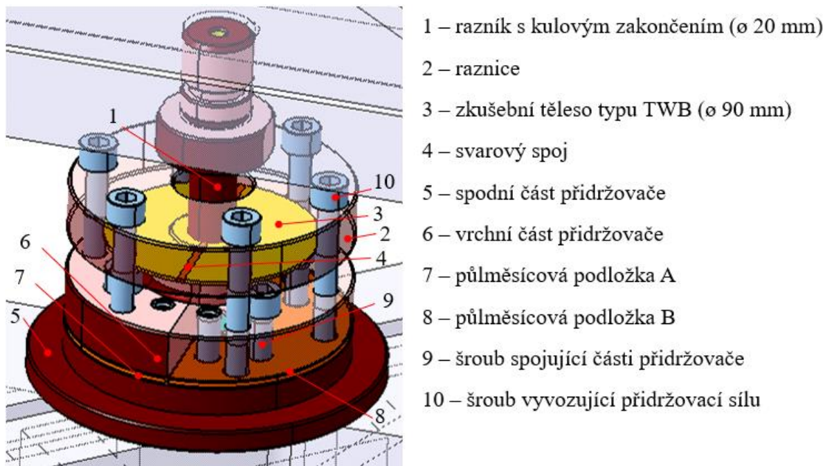
Obr. 52 Schéma přípravku pro zkoušku hloubením dle Erichsena.
