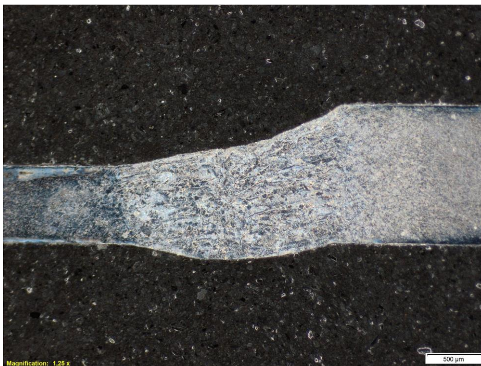
Obr. 59 Makrostruktura svaru A0,7B1,25 / 40 A.
