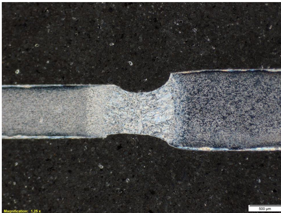
Obr. 60 Makrostruktura svaru A1,2B0,8 / 0 A.
