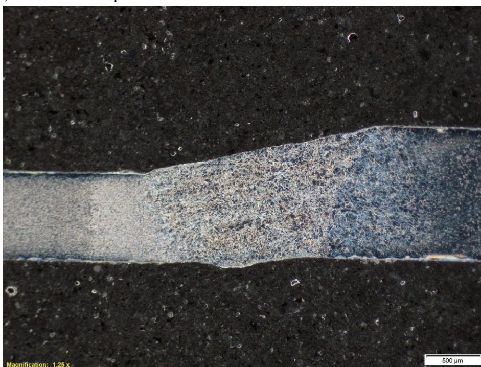
Obr. 62 Makrostruktura svaru A1,2B0,8 / 40 A.
