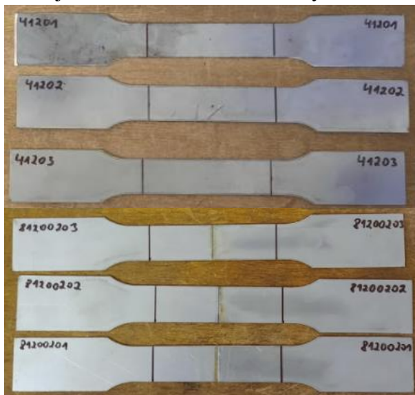
Obr. 44 Příprava vzorků pro zkoušku tahem.
