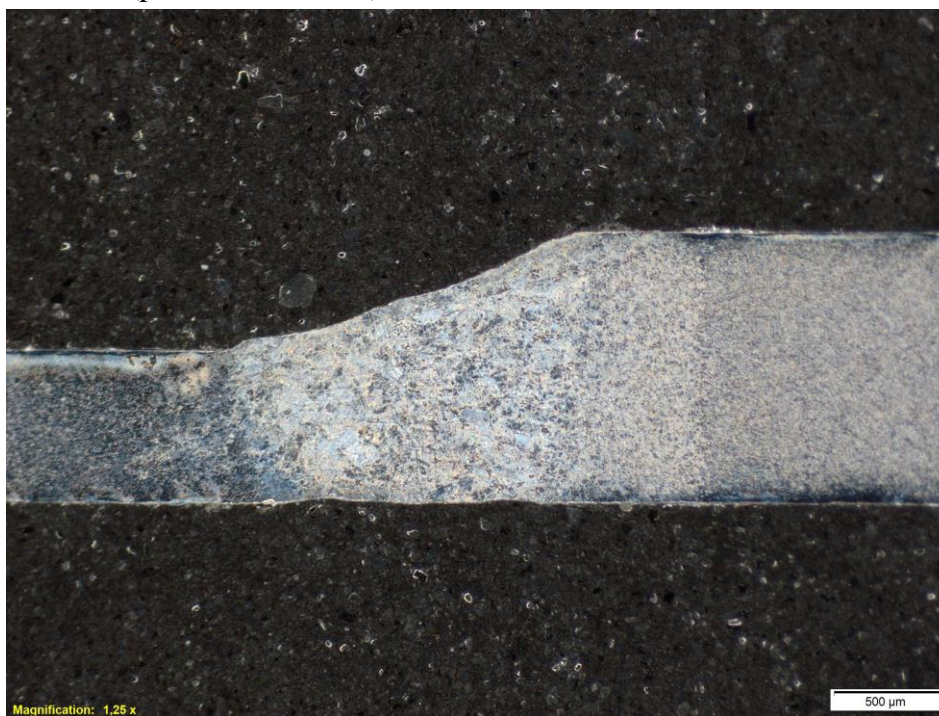
Obr. 58 Makrostruktura svaru A0,7B1,25 / 20 A.
