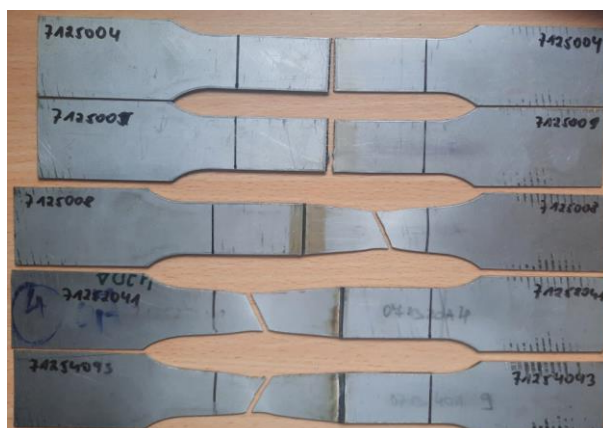
Obr. 48 Vzorky porušené ve svaru i v ZM.
