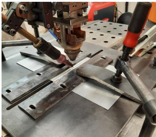
Obr. 40 Upnutí plechů a příprava trajektorie.
