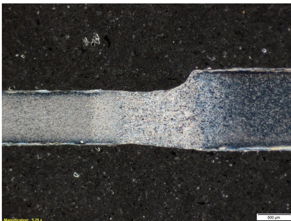
Obr. 61 Makrostruktura svaru A1,2B0,8 / 20 A.
