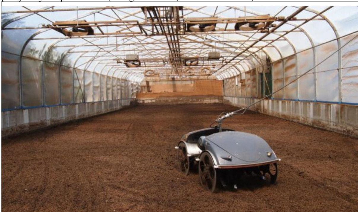
Obrázek 8: Asistované solární sušení separátu
