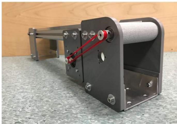
Obr. 4.2.3: Foto pásového dopravníku z bakalářské práce „ Návrh malého pásového dopravníku “ [2]
