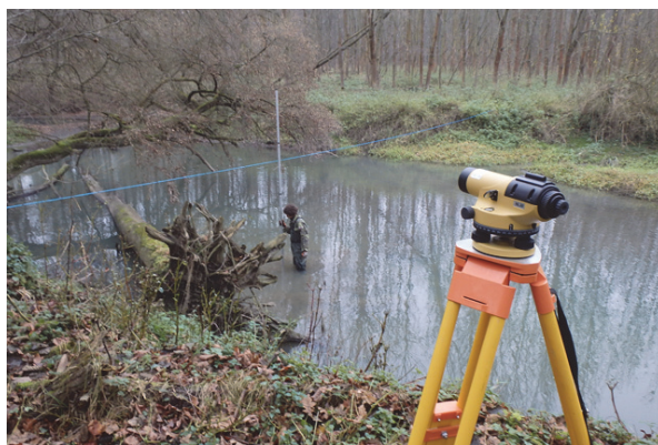
Obr. 8 Ukázka nivelace profilu č. 9 (zdroj: autor)
