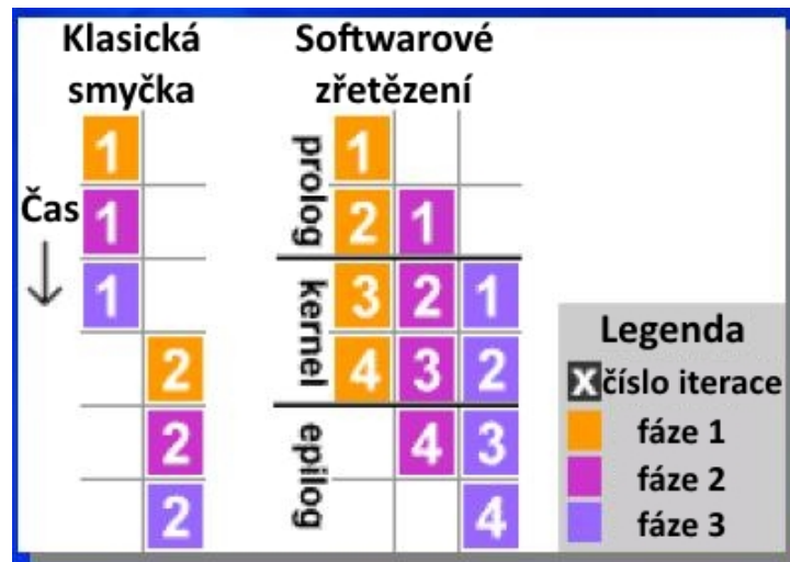
Obrázek 9.2: Princip (schéma) softwarového zřetězení [20]
