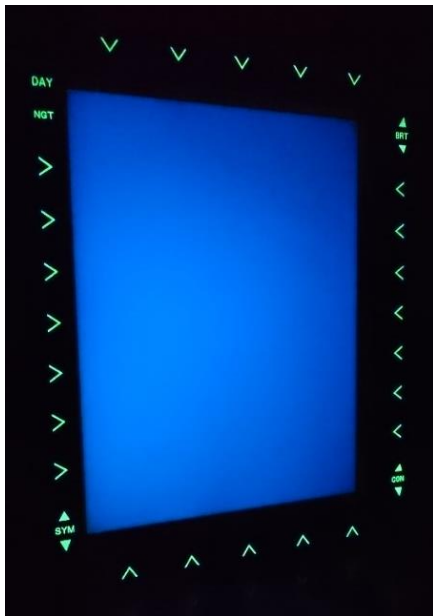
Obrázek 43: MFD s podsvícenými obvodovými tlačítky (symbol šipky) v zatemněné laboratoři.
