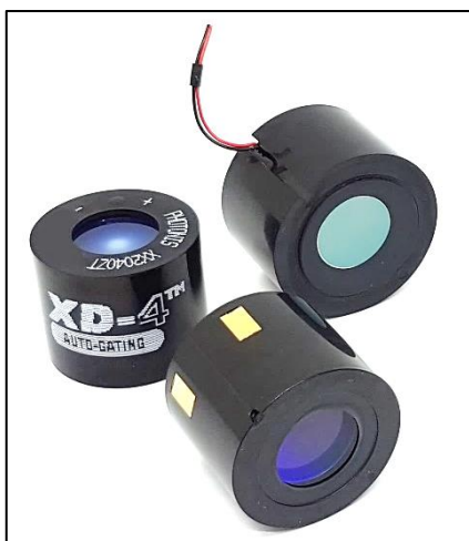
Obrázek 2: Nahoře vpravo MKZJO staršího typu s drátovým připojením napájení, vlevo a uprostřed již standardně napájený MKZJO přítlačnými kontakty a průměrem fotokatody 18 mm.
