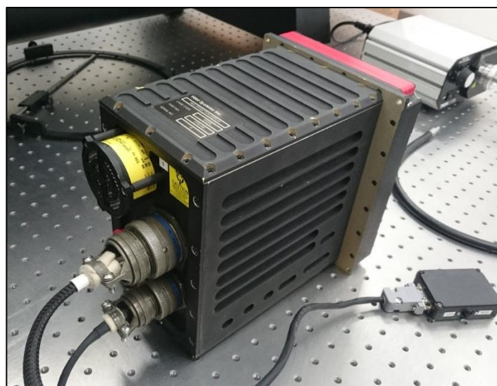
Obrázek 14: MFD ze zadní strany propojeno s napájením a přidatným prototypem ovladače pro přepnutí na zobrazovací režim NVIS.
