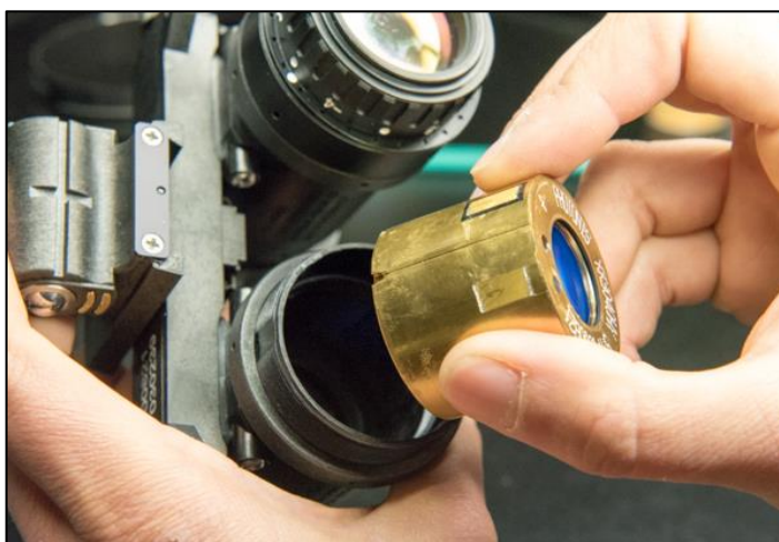
Obrázek 3: Montáž MKZJO do noktovizoru AVS-9. Převzato od Pramacom-HT, spol. s r.o. (Nikol Lach, Vojtěch Zálešák).
