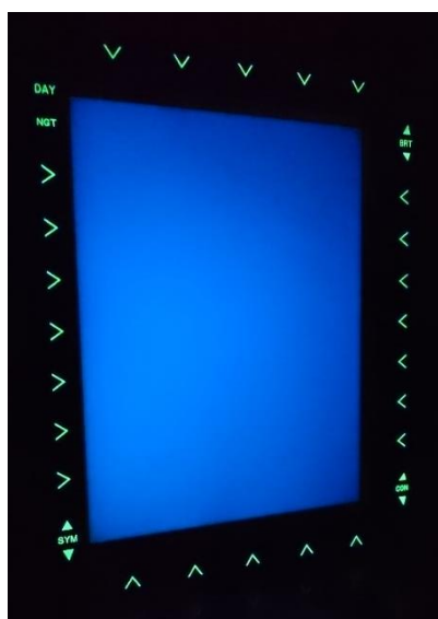
Obrázek 13: MFD při zatemněné laboratoři – můžeme vidět podsvícení ovládacích tlačítek.
