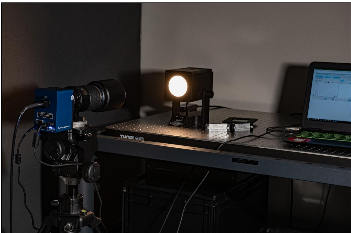
Obrázek 33: Ověřování amplitudové kalibrace spektrometru se zdrojem RS-12DN (při měření byla laboratoř zatemněna a displej notebooku vypnut).
