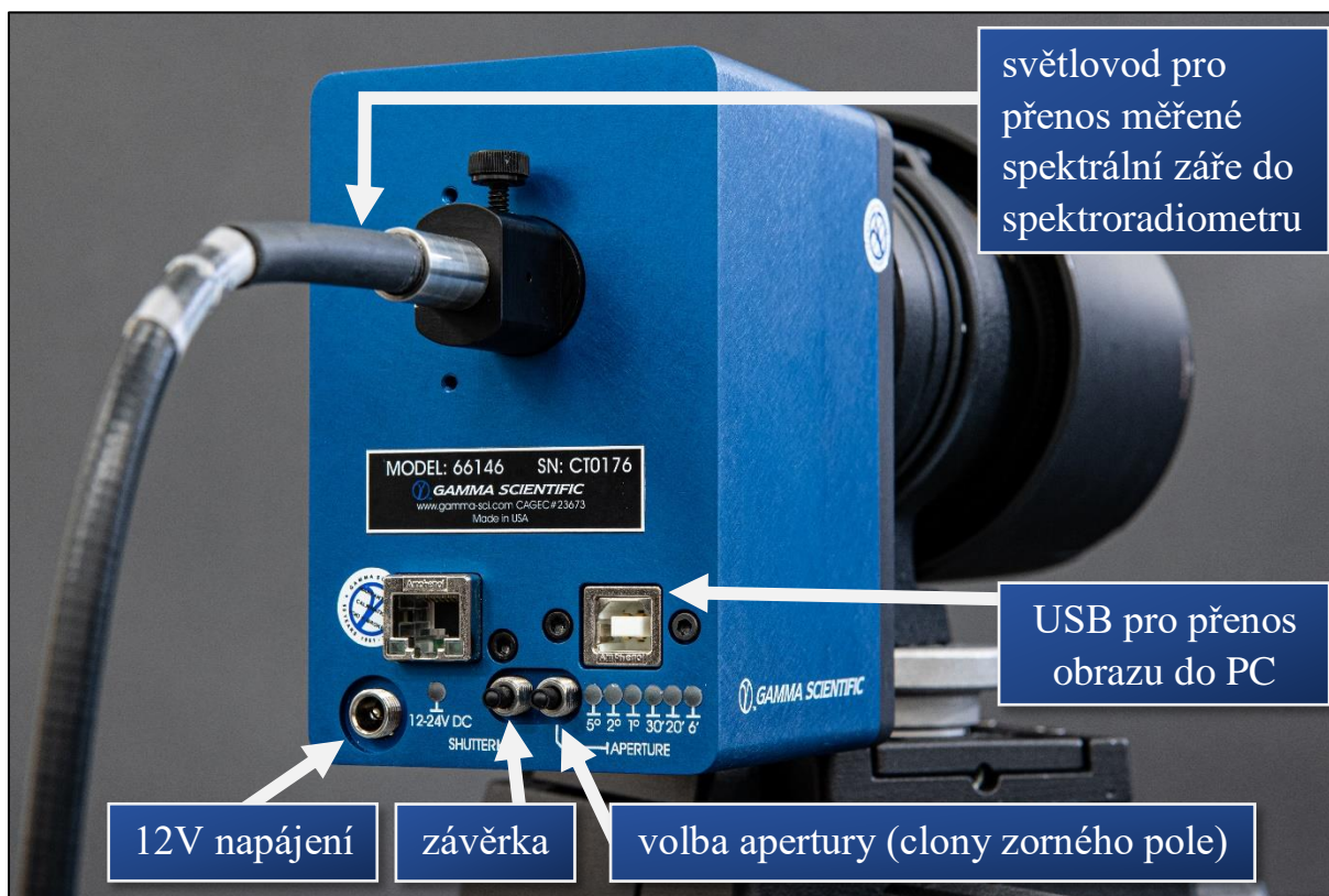
Obrázek 26: Současný nový model externí měřící hlavice s připojeným světlovodem.
