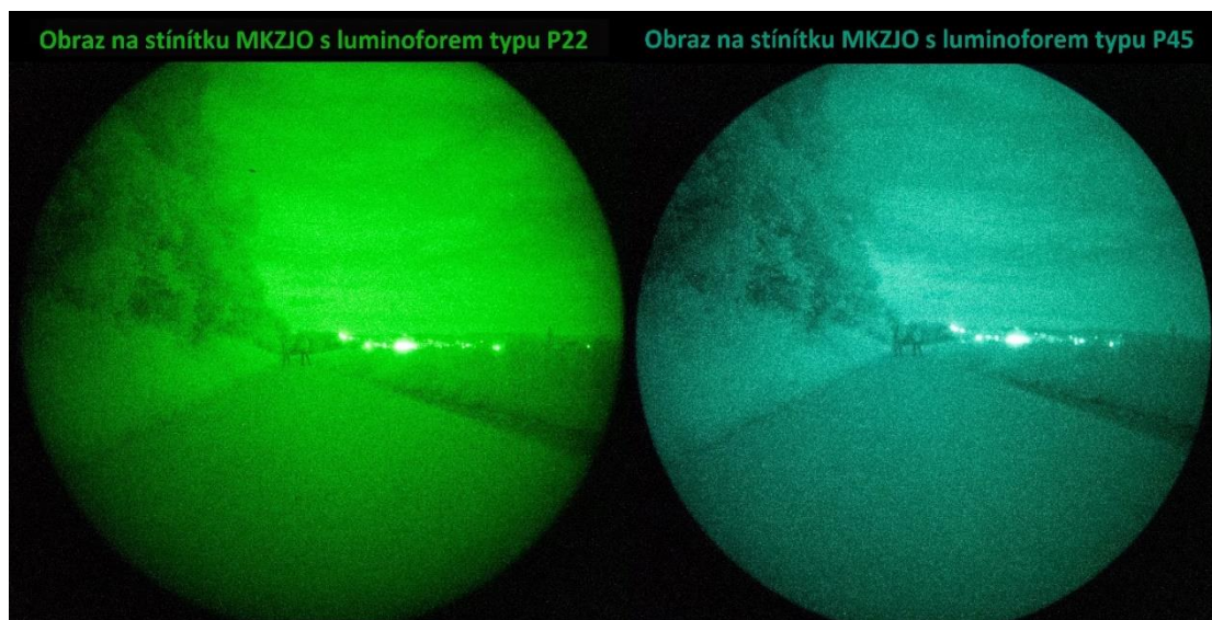
Obrázek 5: Vlevo obraz stínítka MKZJO s luminoforem typu P22, vpravo s typem P45.
