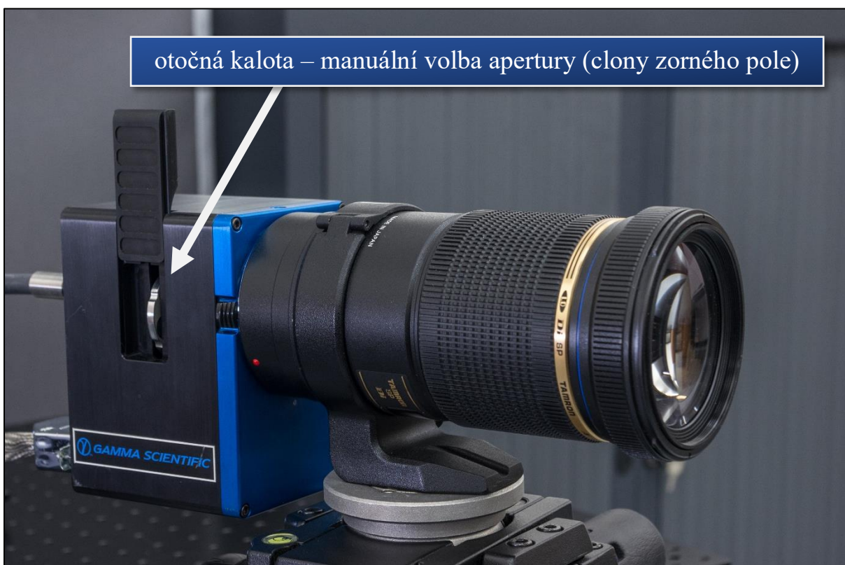
Obrázek 27: Předěšlý model externí měřící hlavice s manuálně otočnou kalotou obsahující clony zorného pole.
