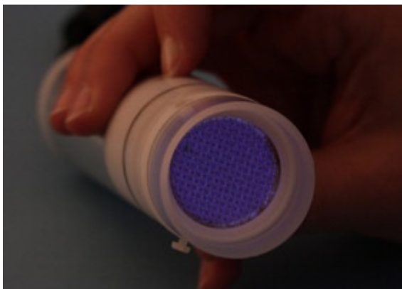
Obrázek 12: Plazmové zařízení určeno pro nepřímou plazmovou aplikaci [16].
