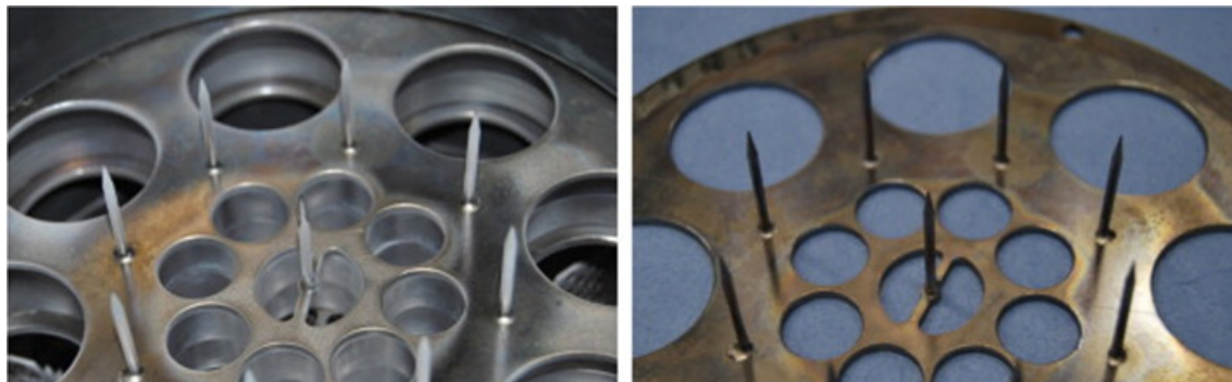
Obrázek 26: Usazeniny na měděných elektrodách [33].
