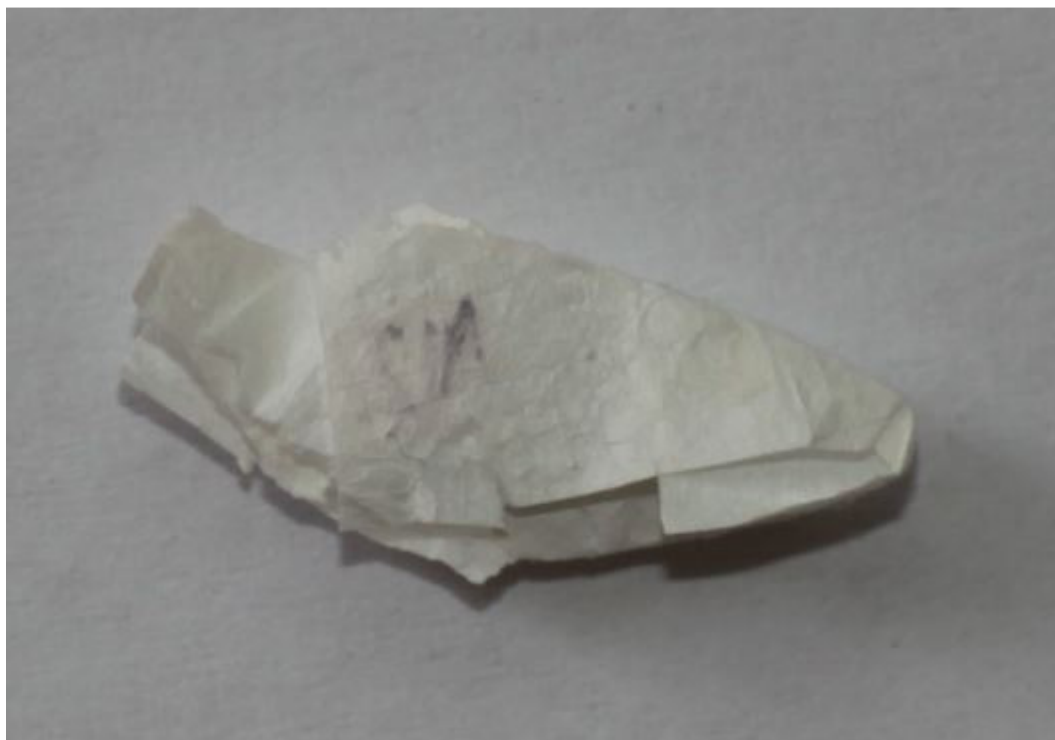
Obrázek 35: Vzorek SiO 2 nanovláknna poškozen analyzačním roztokem.
