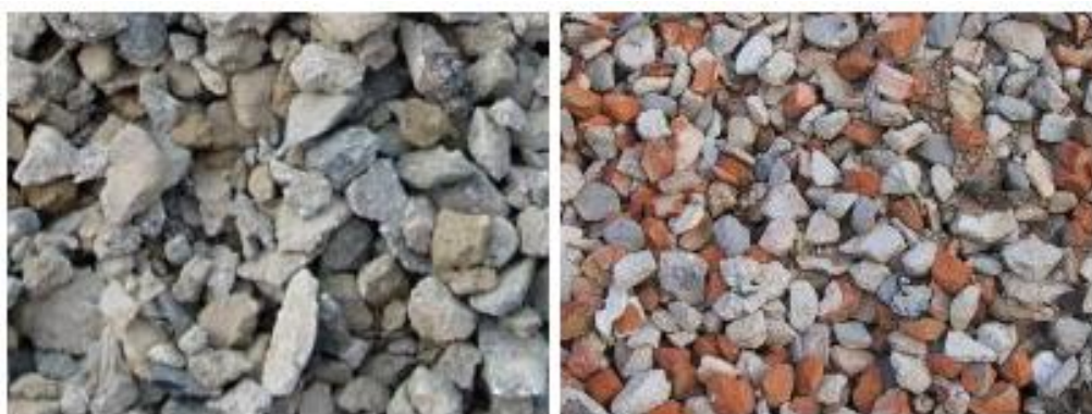
Obr. 3.10 Betónová a tehlová drť spracovaná zo stavebného odpadu
